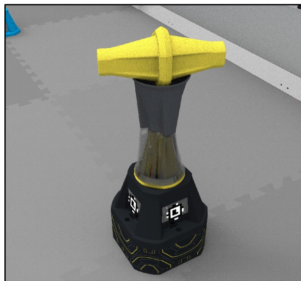
图 SC2-2: 顶部的锥部分与套筒啮合，但是由于套筒半区包含了不止一个锥尖，因此这个锥不被视为安放好状态。
